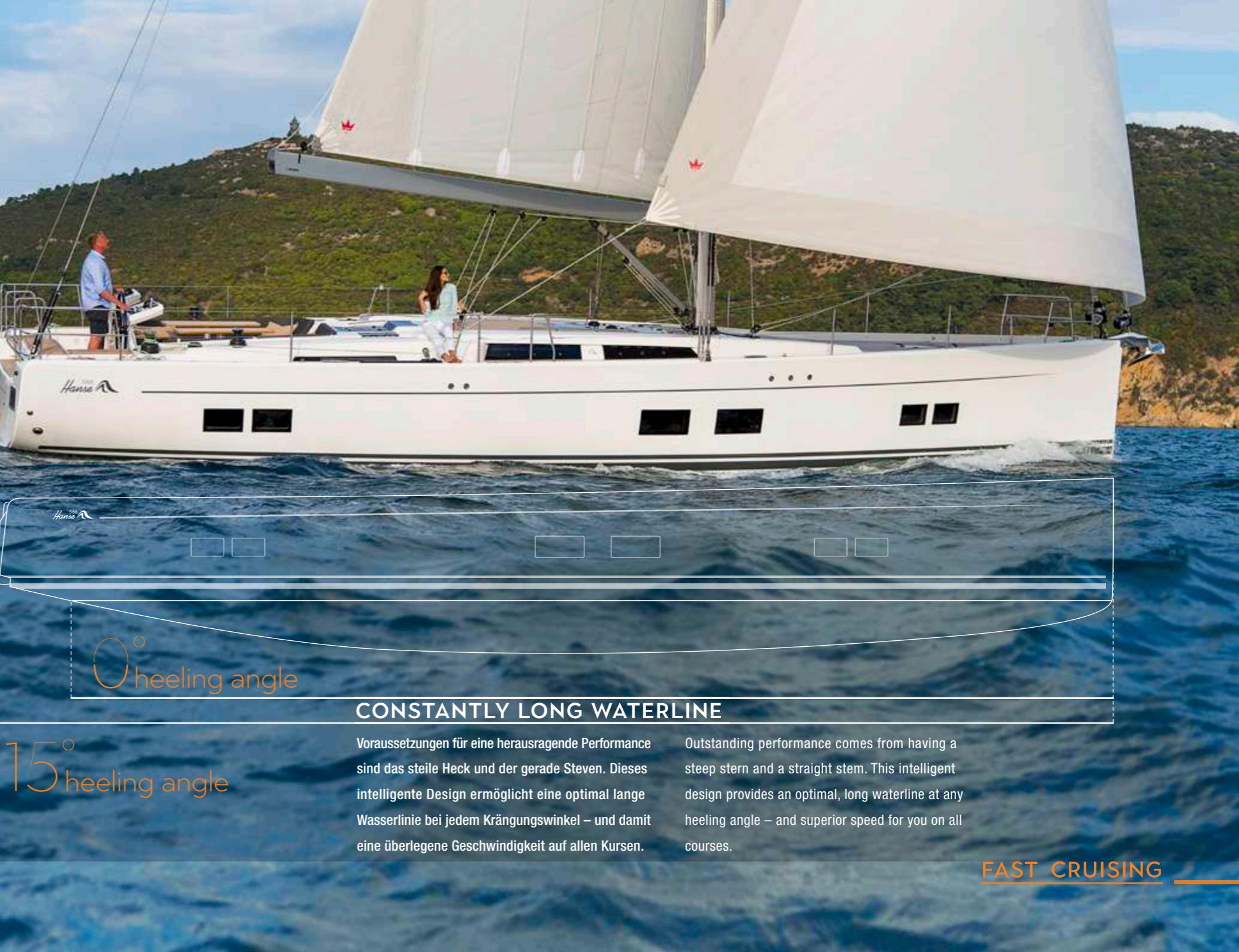
Voraussetzungen für eine herausragende Performance sind das steile Heck und der gerade Steven. Dieses intelligente Design ermöglicht eine optimale lange Wasserlinie bei jedem Krängungswinkel – und damit eine überlegene Geschwindigkeit auf allen Kursen.
